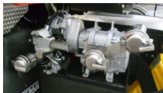
Pompa di travaso
